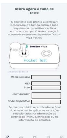
9. Quando solicitado, insira o tubo de teste no equipamento Doctor Vida, desenrosque a tampa, coloque o tubo e enrosque a tampa.
